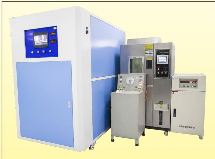
**Apparecchiatura di test di durata elettrica per pressostati.**
