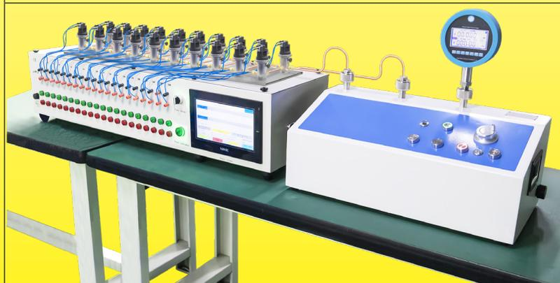
Verifica della calibrazione del pressostato
